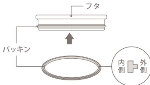
パッキンの取り付け方向に注意して、飲み口本体の溝に合わせて確実に取り付けてください。
